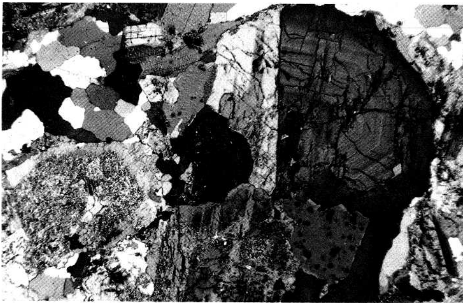
Fot. 10 - Granodiorito de Felgueiras. Plagioclase zonada evidenciando uma densa rede de microfissuras. No canto superior direito é possível observar o progresso da alteração, caracterizada pelas manchas típicas e pela presença, ainda que reduzida, de sericite. Note-se ainda a relativa conservação da biotite, embora alguns cristais apresentem uma certa descoloração (Nícois cruzados; ampliação aproximada de 24x)
