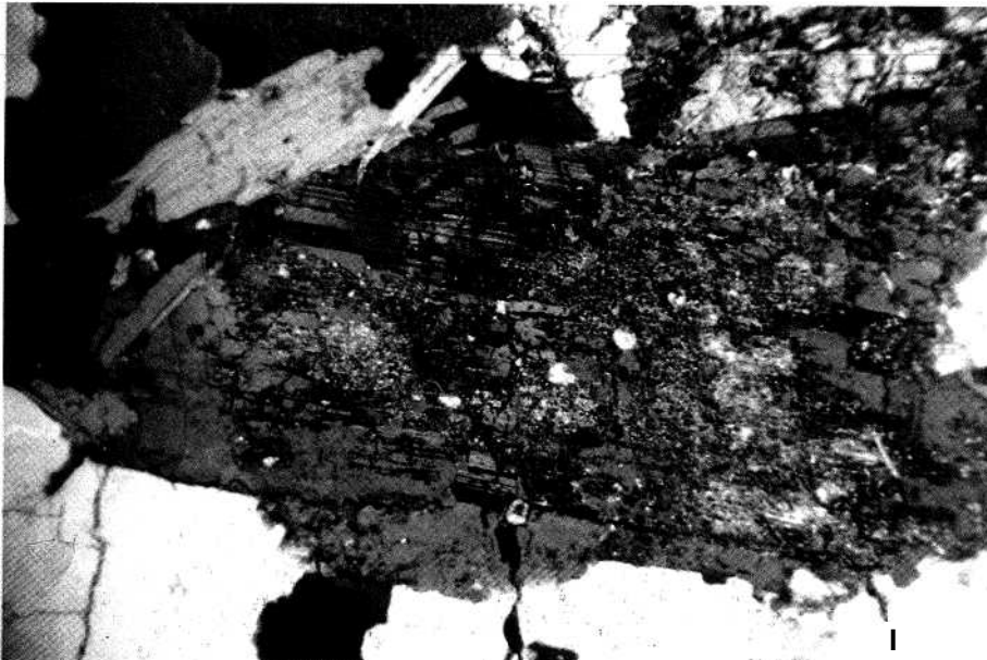
Fot. 24 - Granito de Guimarães e Sto. Tirso, lâmina correspondente a f(g)2. Plagioclase denunciando forte alteração. Note-se a relativa conservação da biotite, embora alguns grãos evidenciem já uma, certa descoloração (Nícois cruzados; ampliação aproximada de 40x)
