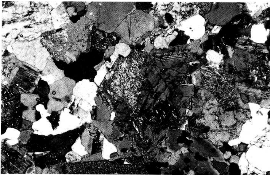
Fot. 26 - Granito de Burgães, lâmina correspondente a fibj1. Note-se a forte presença dos óxidos/hidróxidos de ferro (Nícois cruzados; ampliação aproximada de 40x)
