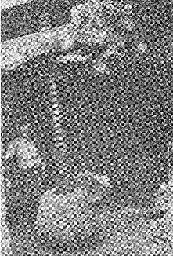
Fig. 2 — Cabeça da vara com seu fuso e peso. No colo do raizeiro vê-se o topo da *concha*, taboão rectangular onde foi talhada a rosca do parafuso. É atravessada pelo fuso, que rodando à direita ou à esquerda faz subir ou descer a vara.
